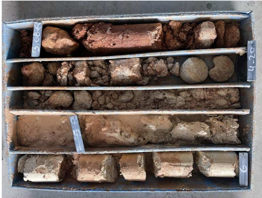
Foto 17: Caja porta testigos SONDEO 3 CAJA 2
