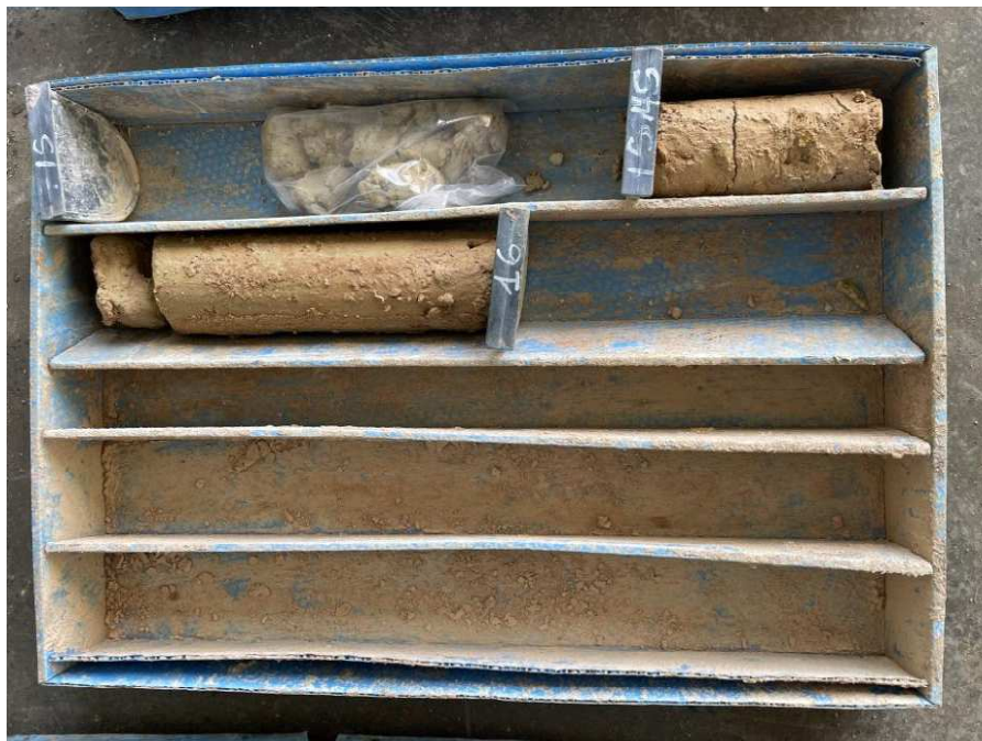
Foto 42: Caja porta testigos SONDEO 9 CAJA 6
