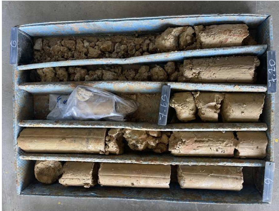
Foto 53: Caja porta testigos SONDEO 13 CAJA 3
