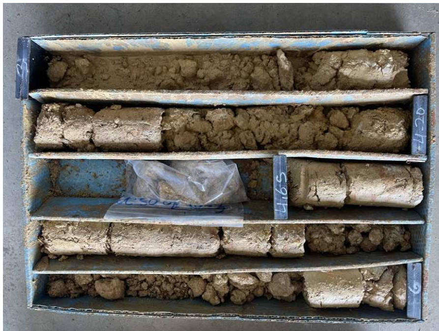
Foto 52: Caja porta testigos SONDEO 13 CAJA 2
