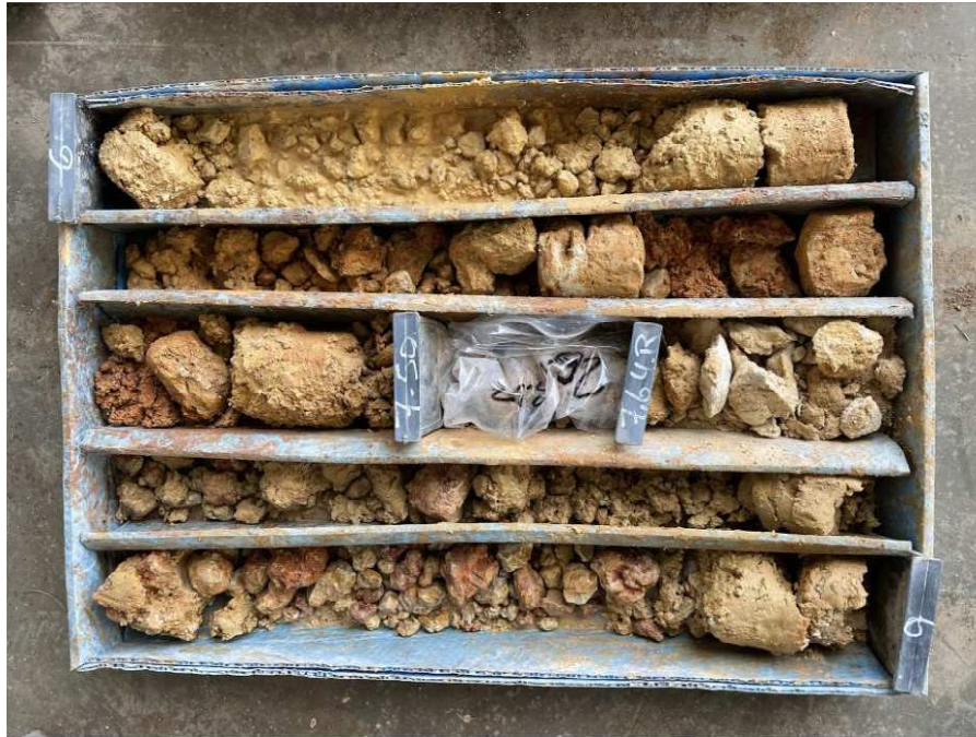
Foto 39: Caja porta testigos SONDEO 9 CAJA 3
