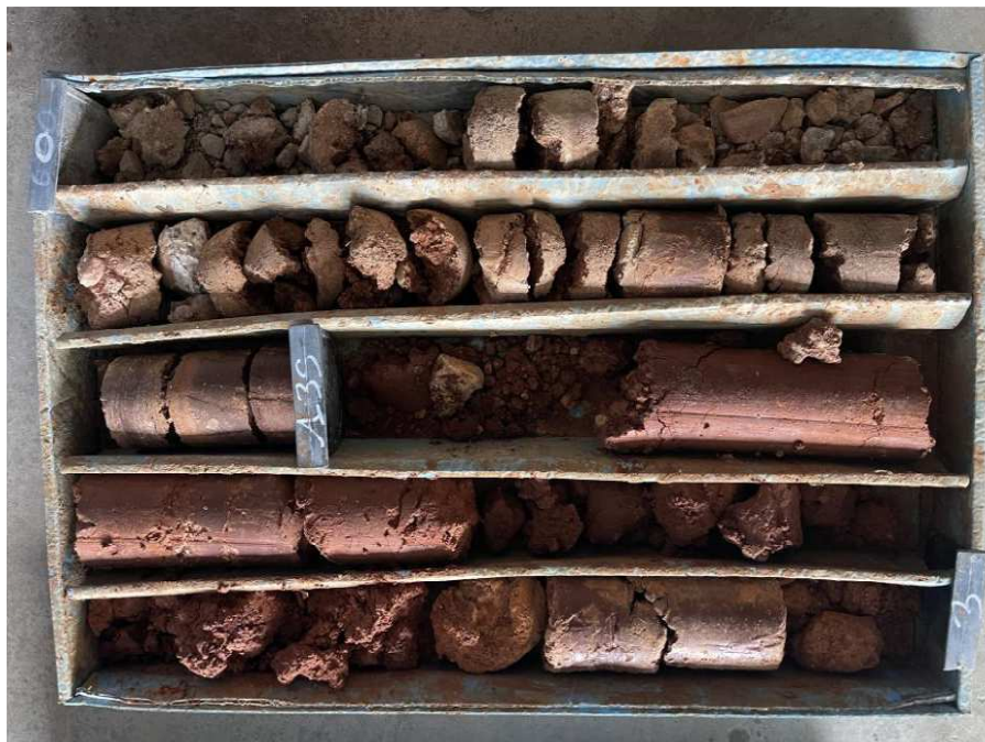
Foto 16: Caja porta testigos SONDEO 3 CAJA 1
