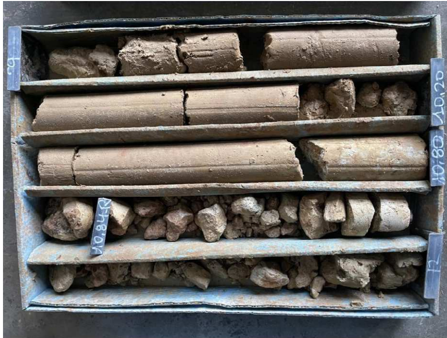
Foto 61: Caja porta testigos SONDEO 15 CAJA 4
