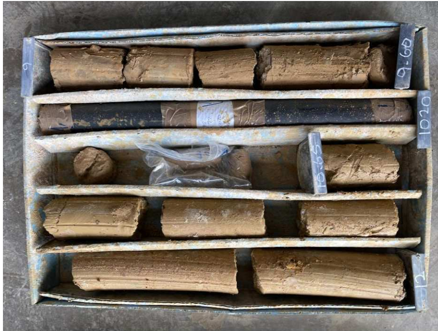
Foto 47: Caja porta testigos SONDEO 11 CAJA 4
