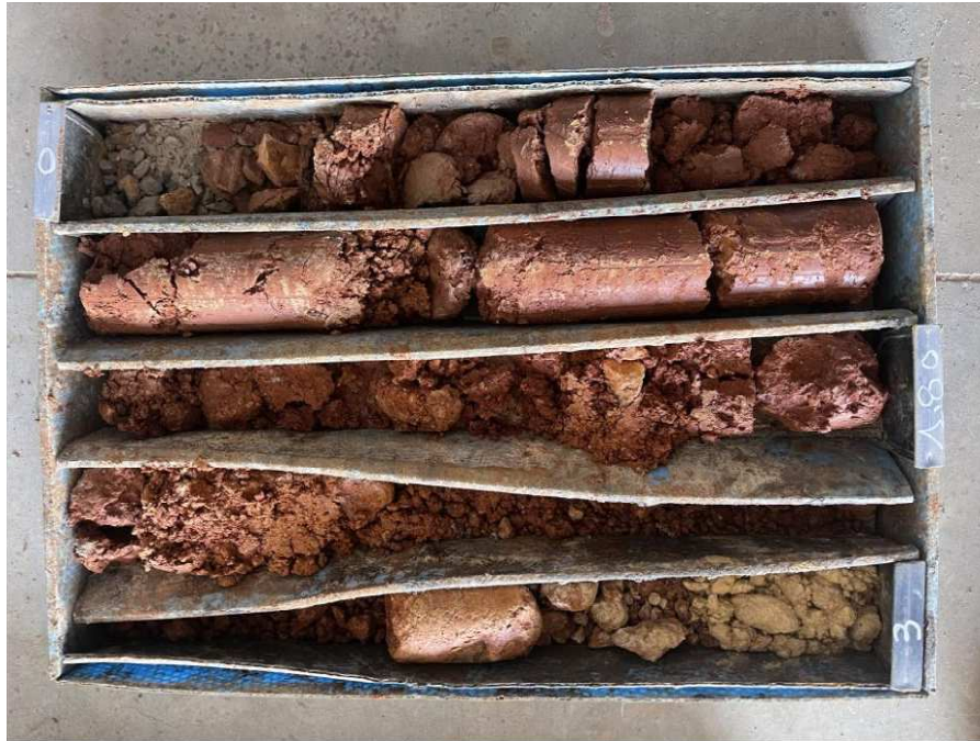
Foto 51: Caja porta testigos SONDEO 13 CAJA 1
