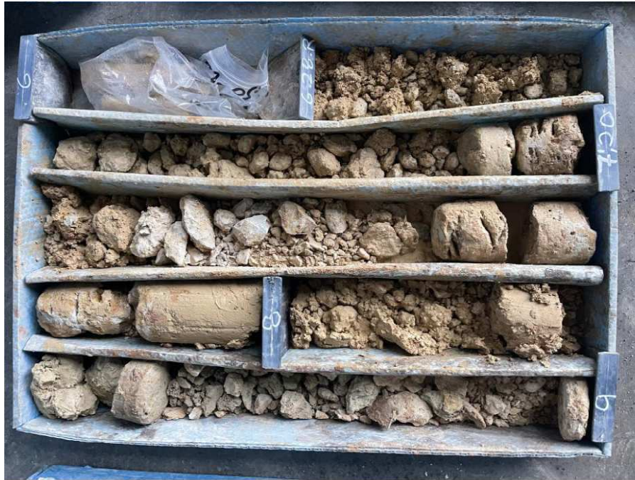
Foto 25: Caja porta testigos SONDEO 5 CAJA 3
