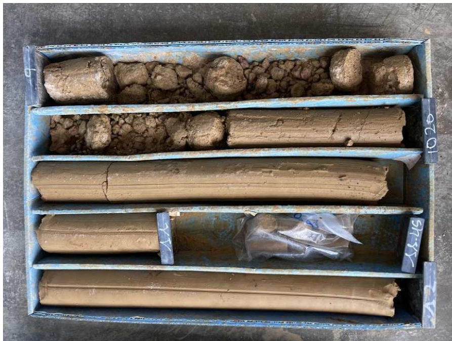
Foto 12: Caja porta testigos SONDEO 1 CAJA 4
