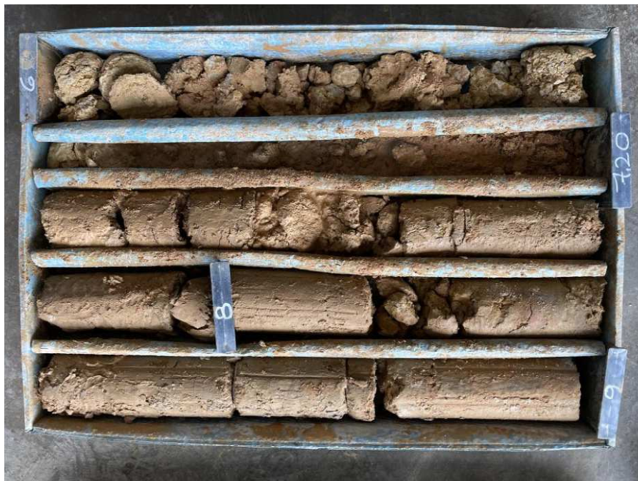
Foto 46: Caja porta testigos SONDEO 11 CAJA 3
