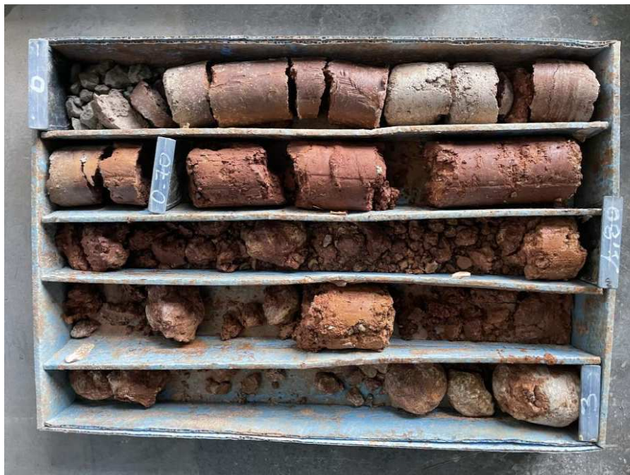
Foto 58: Caja porta testigos SONDEO 15 CAJA 1
