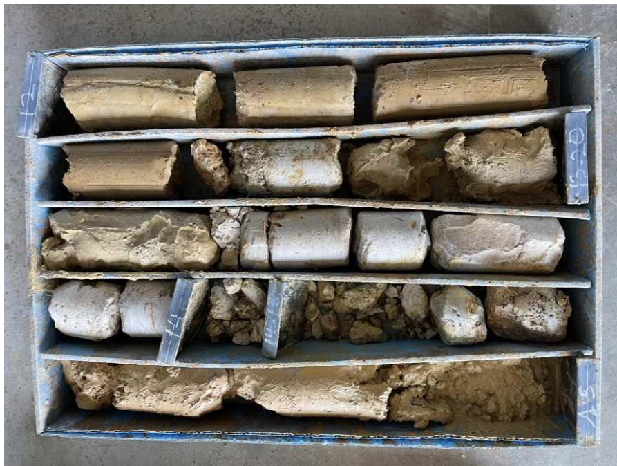
Foto 34: Caja porta testigos SONDEO 7 CAJA 5
