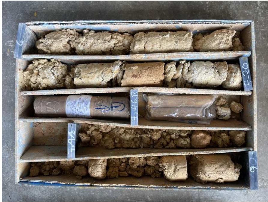
Foto 11: Caja porta testigos SONDEO 1 CAJA 3
