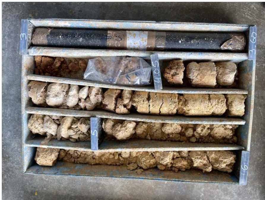
Foto 10: Caja porta testigos SONDEO 1 CAJA 2
